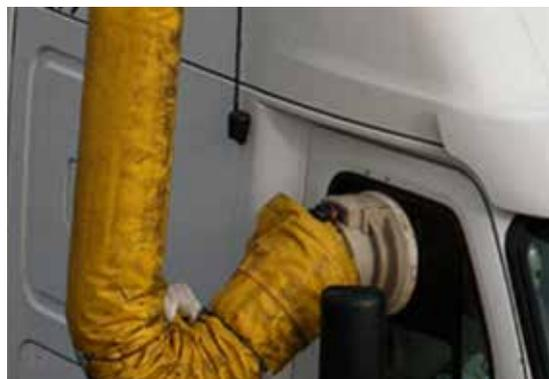
Рис. 5. Оборудование для подключения автопоезда к стационарной климатической установке IdleAir на паркинге, США [9]
