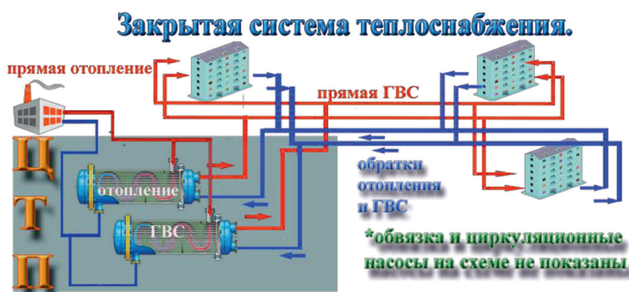
Рис. 1. Закрытая система теплоснабжения
