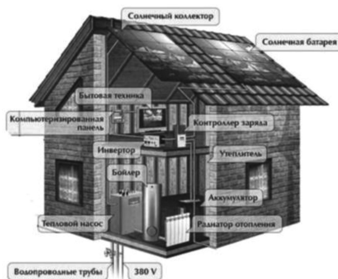
Рис. 3. Комбинированная система электрообогрева дома
