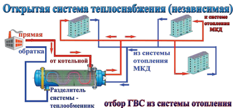
Рис. 2. Открытая система теплоснабжения
