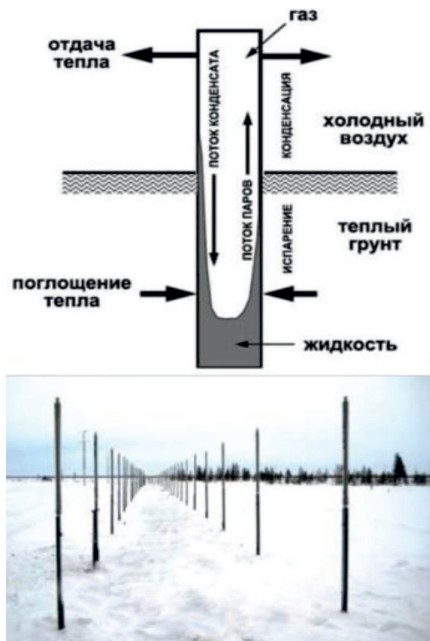
Рис. 3. Устройство термостабилизатора и расположение термостабилизаторов вдоль дорожного полотна [9, с. 11]
