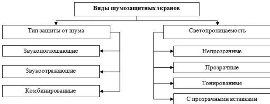
Рис. 3. Классификация шумозащитных экранов
